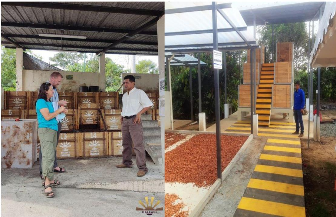
*Configuration de fermentation du cacao de qualité en Equateur : les caisses de fermentation sont superposées les unes aux autres ce qui permet par ouverture d'un côté le transfert d'une caisse à l'autre (gravitation) sans manutention excessive. Cela évite aussi les erreurs de traçabilité des lots entre les différentes colonnes de caisses qui sont numérotés.*
